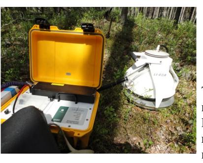
Эмиссию CO2 с поверхности почвы измеряли при помощи инфракрасного газоанализатора LI COR 8100 с почвенной камерой 20 см с мая по октябрь 2014—2017 гг. один-два раза в месяц.
